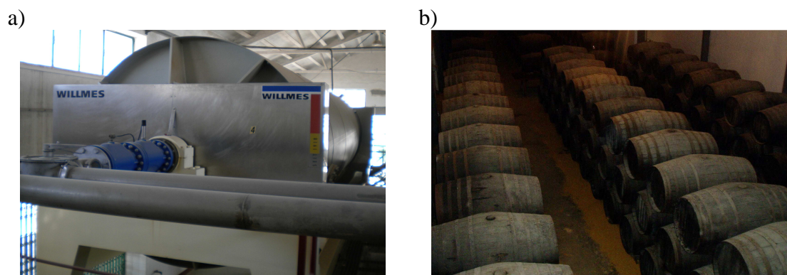
Figura 2. Industria vitivinícola: (a) prensa neumática de membrana; (b) disposición de los barriles en la bodega.
