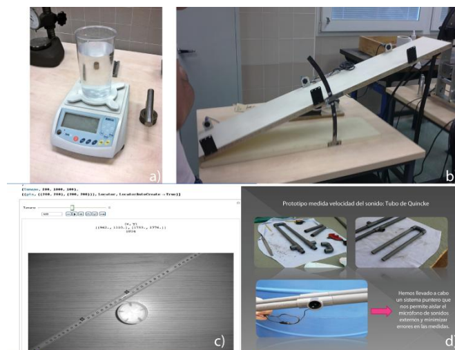
Figura 3. Ejemplo de prototipos diseñados. Medida de a) densidad, b) fricción, c) longitud, d) sonido
