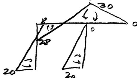
(T1) El sentido es que ambos mecanismos tienen igual probabilidad de colapso
