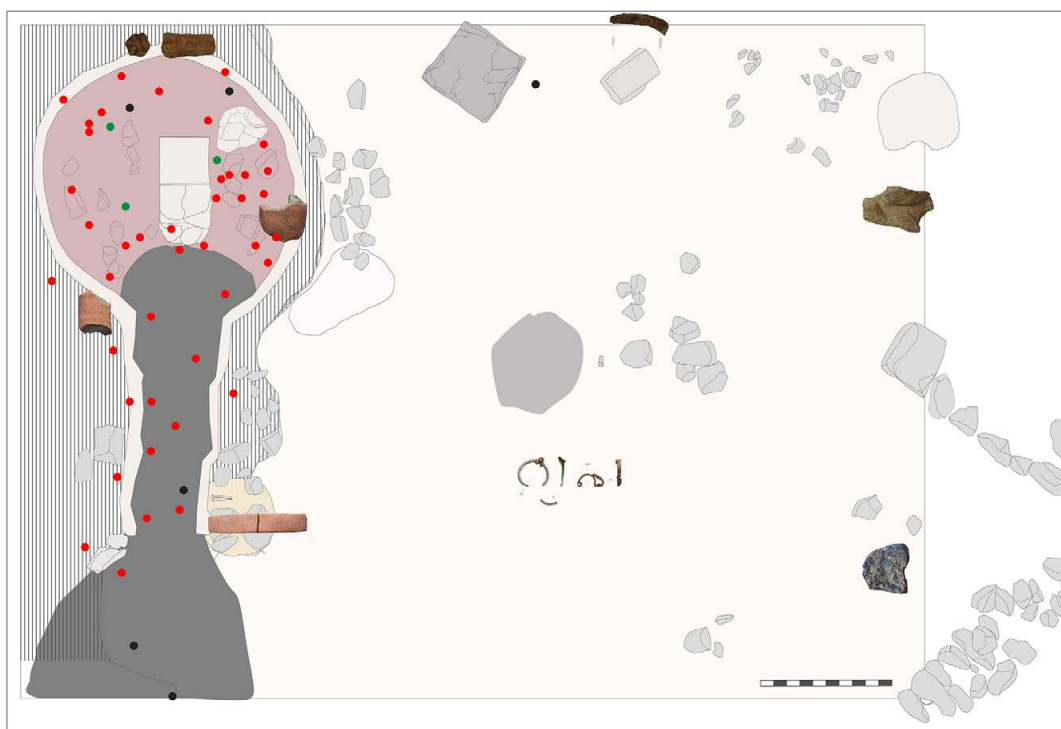
Fig. 4. Resultado del mapeo de escorias realizado sobre la planta del Sondeo 2 (rojo: adobes escorificados y vitrificados, negro: escorias de hierro, verde (escorias de hierro con presencia de cobre).
