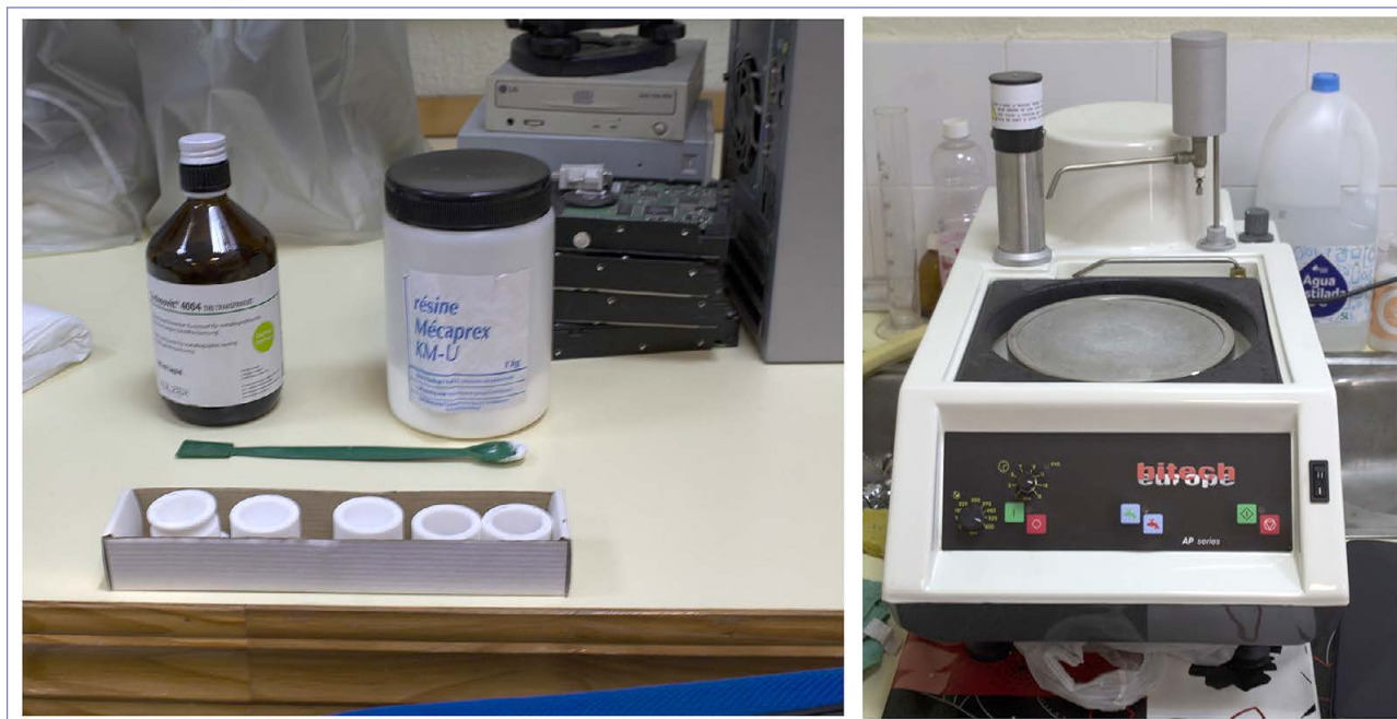
Fig. 7. Elementos para la preparación de las muestras (izq.) y pulidora empleada en el desbaste de las probetas (derch.).
