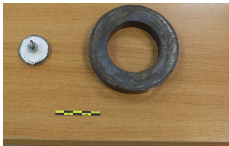
Fig. 6. Peso de precisión empleado para medir el magnetismo de las escorias (izq.). imanes utilizados para clasificar las escorias según su magnetismo.
