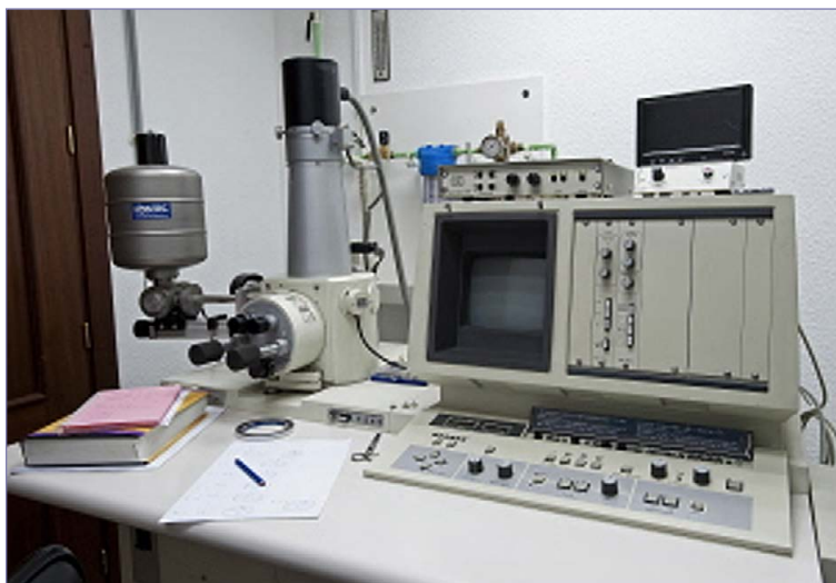
Fig. 12. Equipo SEM-EDX empleado en los análisis de escorias de la Facultad de Farmacia de la Universidad de Granada.
