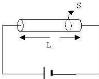
Basándonos en la analogía con un condensador, el campo eléctrico y, por tanto, las líneas de corriente van a estar dirigidas según la generatriz del cilindro, siendo  $\mathbf{J}$  constante entre las placas metálicas.
