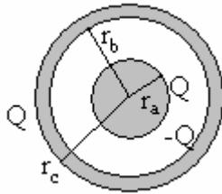
La carga en la superficie interior del conductor exterior ( $r_b$ ) es  $-Q$ , ya que esta superficie envuelve la carga del conductor interior.
